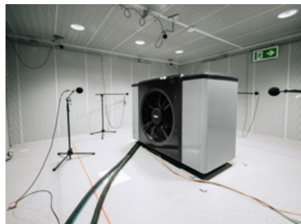
Das WOLF Schalllabor ist für Schalleistungsmessungen der Genauigkeitsklasse 2 zertifiziert. Der Schalleistungspegel der Geräte wird entsprechend dieser Norm (ISO 3744) durch das Hüllflächenverfahren mit mindestens neun Mikrofonen bestimmt.
